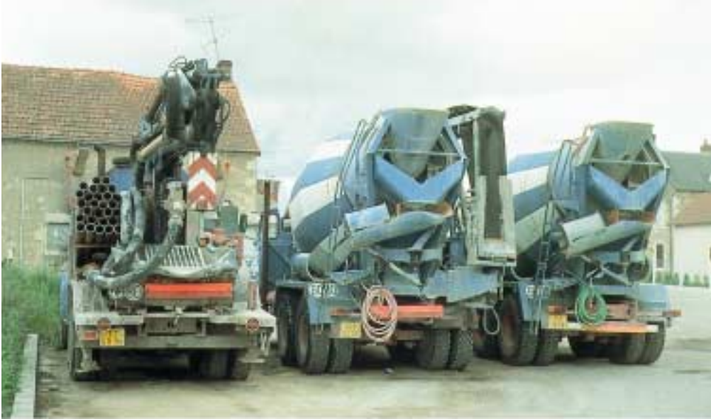
Camions malaxeurs, avec pompe à béton, tapis-transporteur ou goulotte.
