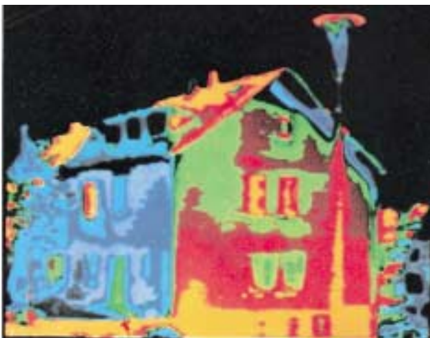
La thermographie permet de déterminer avec précision les zones de déperdition d'une construction.
