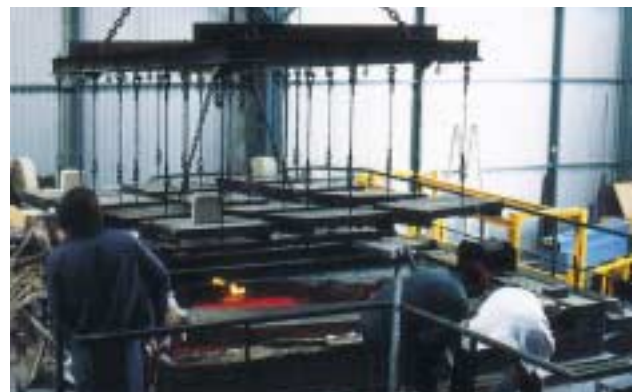
Essai de plancher béton sur four horizontal
