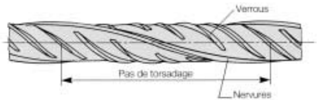
Armatures torsadées à froid à verrous transversaux obliques en croissant.
