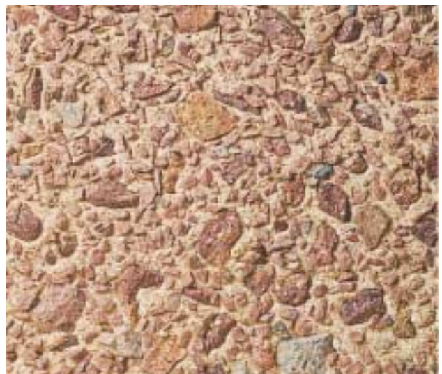
L'apparence découle à la fois du choix des composants du béton et du traitement de surface.
